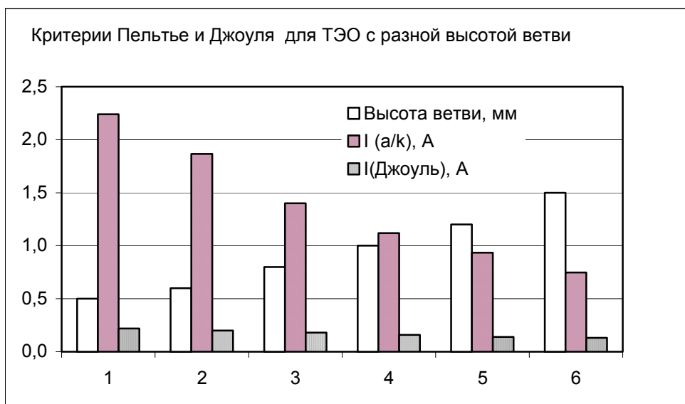
Рис.1.1а. Сравнительная диаграмма требований Пельтье и Джоуля, накладываемых на значения измерительного электрического тока для ТЭО, отличающихся высотой ветвей. Испытываемые ТЭО - 1МС04-004-(05 – 15).
